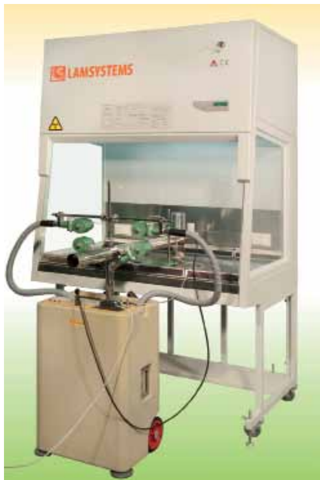
Процесс тестирования бокса биологической безопасности II класса с использованием оборудования английского производства.
