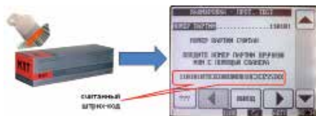
Рис. 2. Пример ввода серии реагента с помощью сканера штрих-кода
